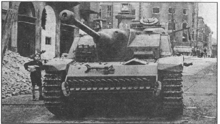
Довольно опасный противник T-34 - штурмовое орудие на базе танка Pz.III - StuG40 с 75-мм пушкой L/48. 9.05.45.
