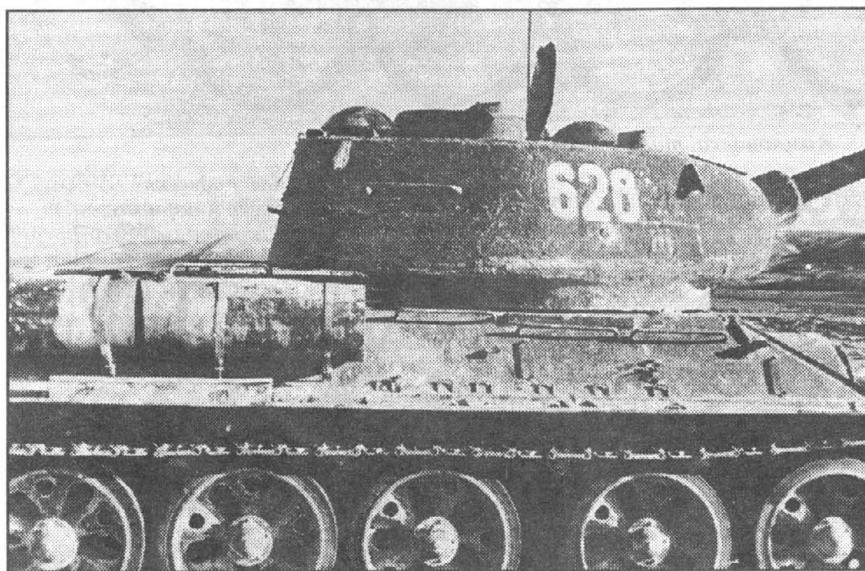
Этот тип башни Т-34-85 отличался грубой формой поверхности - результат другой технологии литья. Катки уже от танка Т-54.
