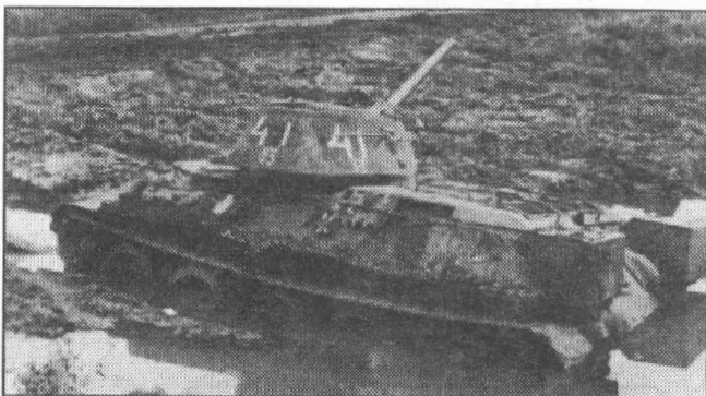
Застывший в грязи Т-34 сормовского завода (на корме закреплены дополнительные топливные баки коробчатой формы)
