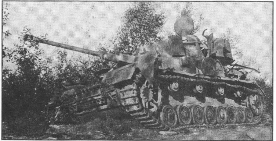
Самый массовый немецкий танк - Pz.IV модификации J с длинноствольной 75-мм пушкой L/48.
