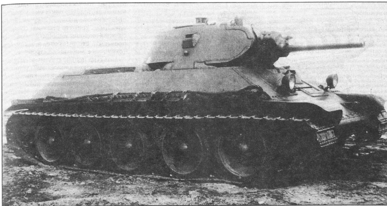
Т-34 выпуска 1940 г. со сварной башней и пушкой Л-11
