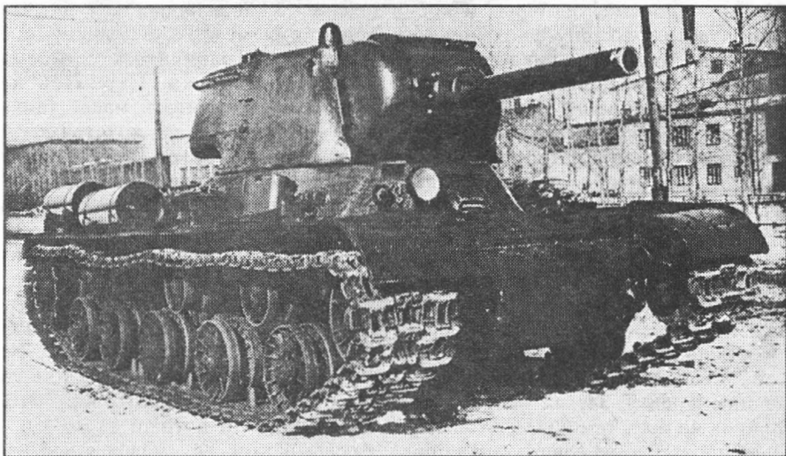
"Средний-тяжелый" танк KV-13 в двух вариантах - с 76-мм пушкой (вверху) и 122-мм гаубицей (внизу).
