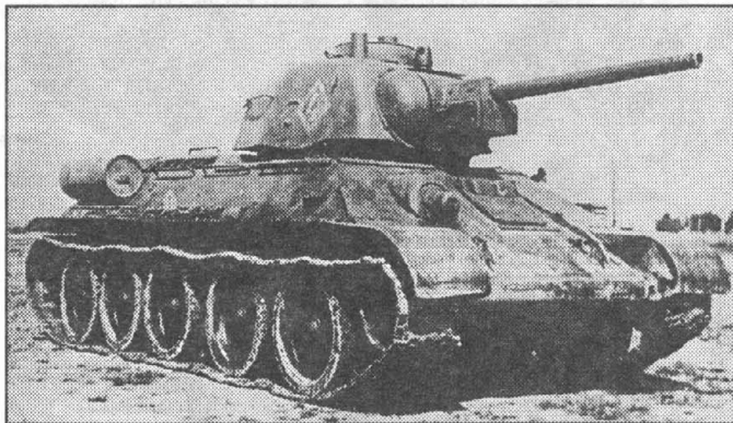
Огнеметный танк ОТ-34 образца 1943 г. Отличительной особенностью этой машины является штампованная башня челябинского завода.
