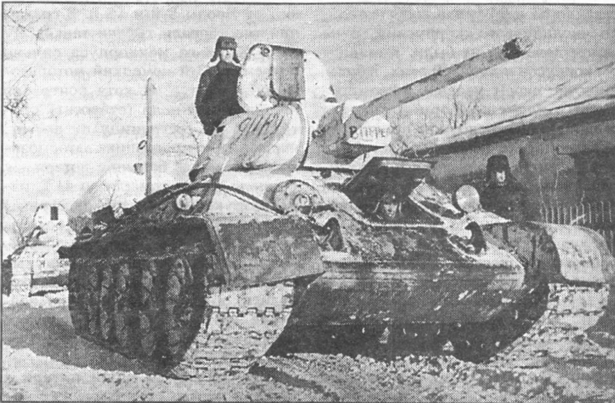
Т-34 в боях под Москвой зимой 41-42 гг. На танке применены гусеницы с уширенными траками
