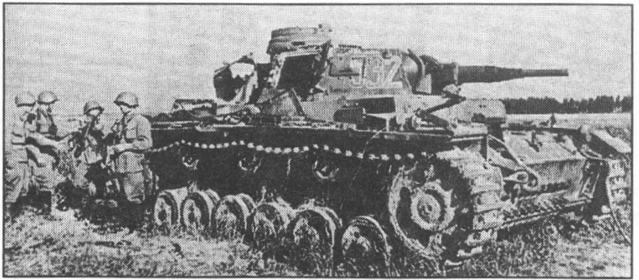
Основной противник T-34 в начале войны - Pz.III (на фото показан Pz.III Ausf.F). Обратите внимание на короткоствольную 50-мм пушку, практически неспособную пробивать броню T-34. 20.07.41.
