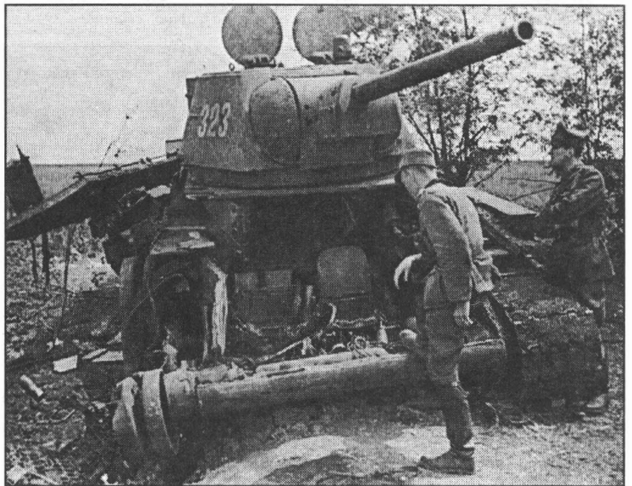
Один из недостатков компоновки Т-34 - размещение четырех передних топливных баков в боевом отделении... "Куда ударила болванка?" - в полупустые баки, а поры дизельного топлива взрываются не хуже паров бензина...
