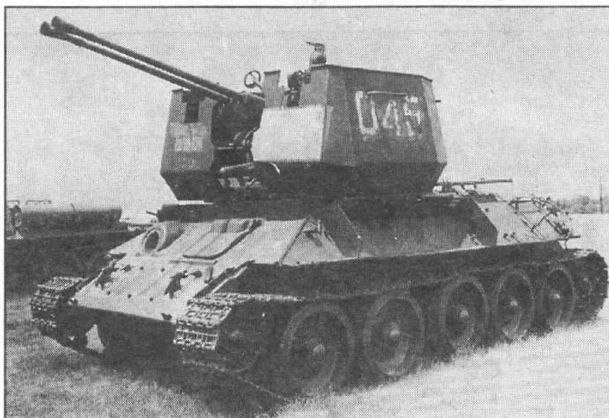
Северовьетнамская ЗСУ на базе Т-34 со спаркой 37-мм автоматов
