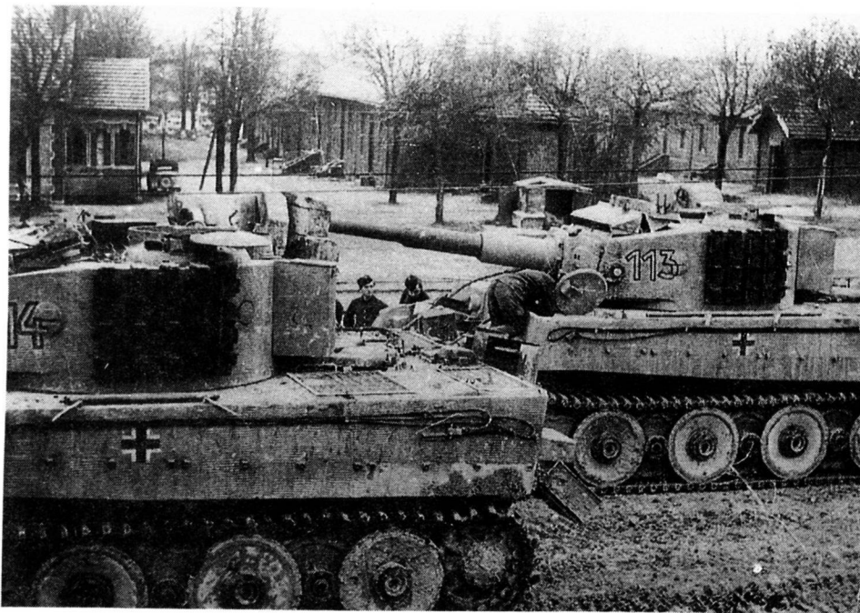
«Тигры» после перевозки по железной дороге — у танков демонтированы наружные катки и надеты узкие транспортные гусеницы. Размещение запасных траков на бортах башни практиковалось со второй половины 1943 года.
