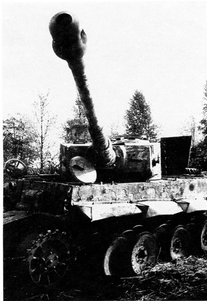
Еще один подбитый «Тигр», так называемой «промежуточной» модели, выпуска конца 1943 — начала 1944 года. Опорные катки еще с резиновыми бандажами, но фара уже на лобовом листе, новая командирская башенка, бинокулярный прицел, циммерит...
