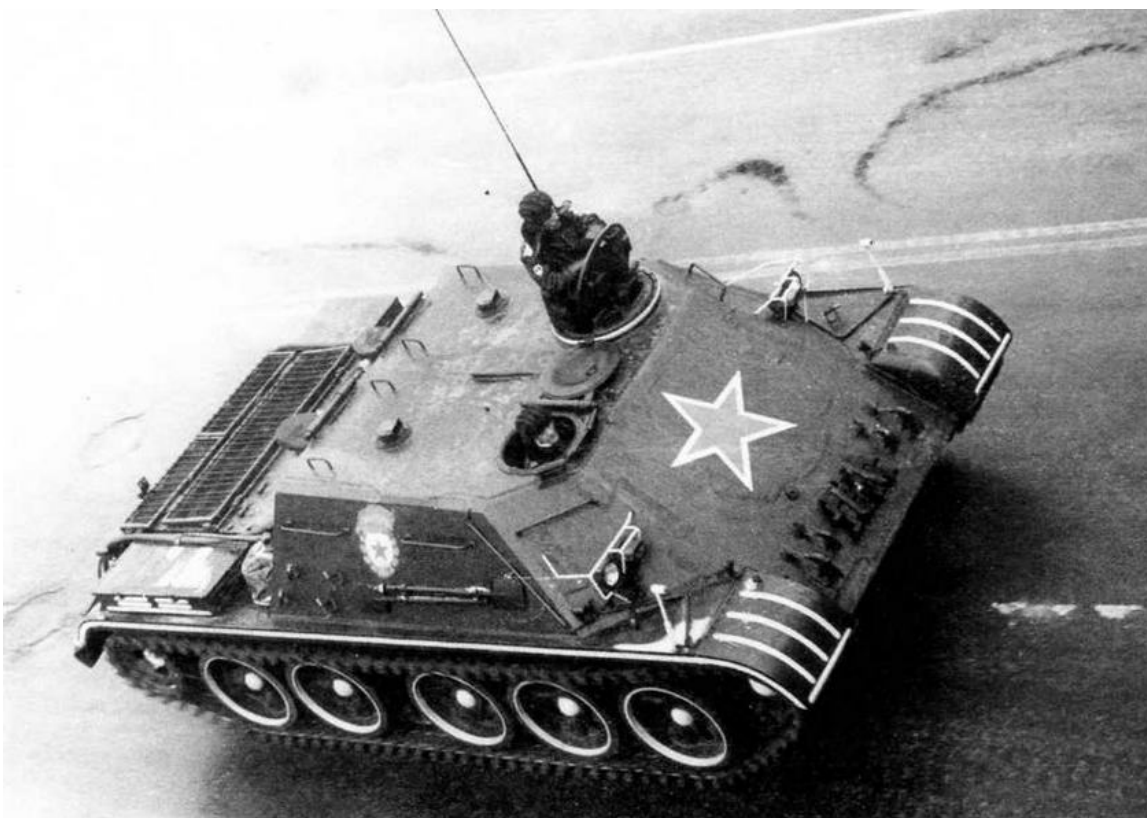
Тягач, переоборудованный из СУ-122, — неперенный участник технического обеспечения московских парадов 1970 — 1990 годов
