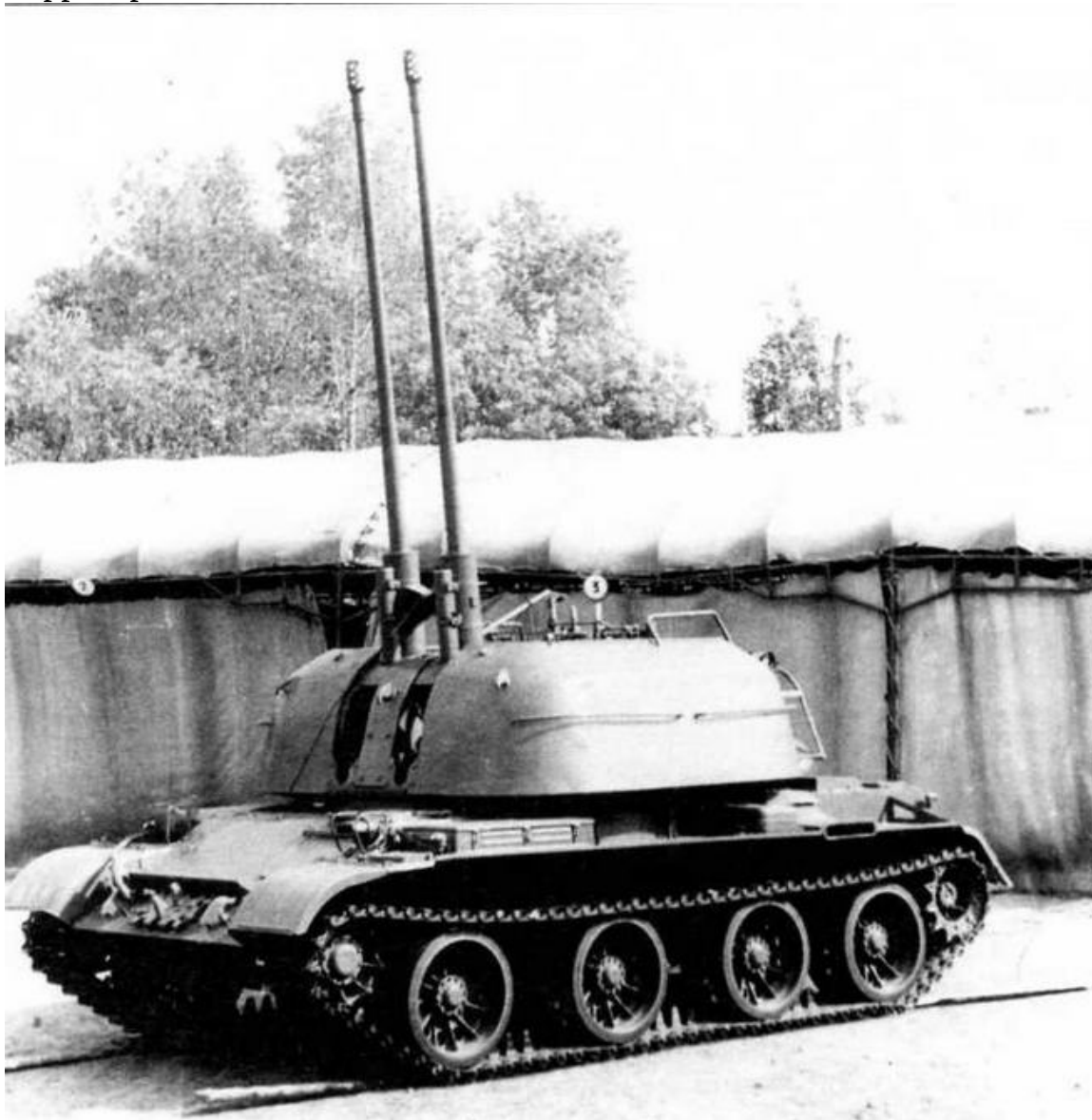
ЗСУ-57-2 со стволами 57-мм спаренной автоматической пушки, поднятыми на максимальный угол возвышения
