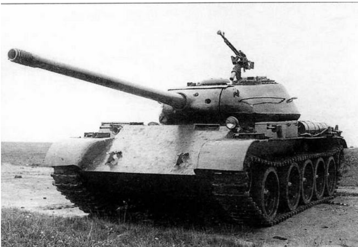
Опытный образец Т-54, вооруженный 100-мм пушкой ЛБ-1. 1945 год
