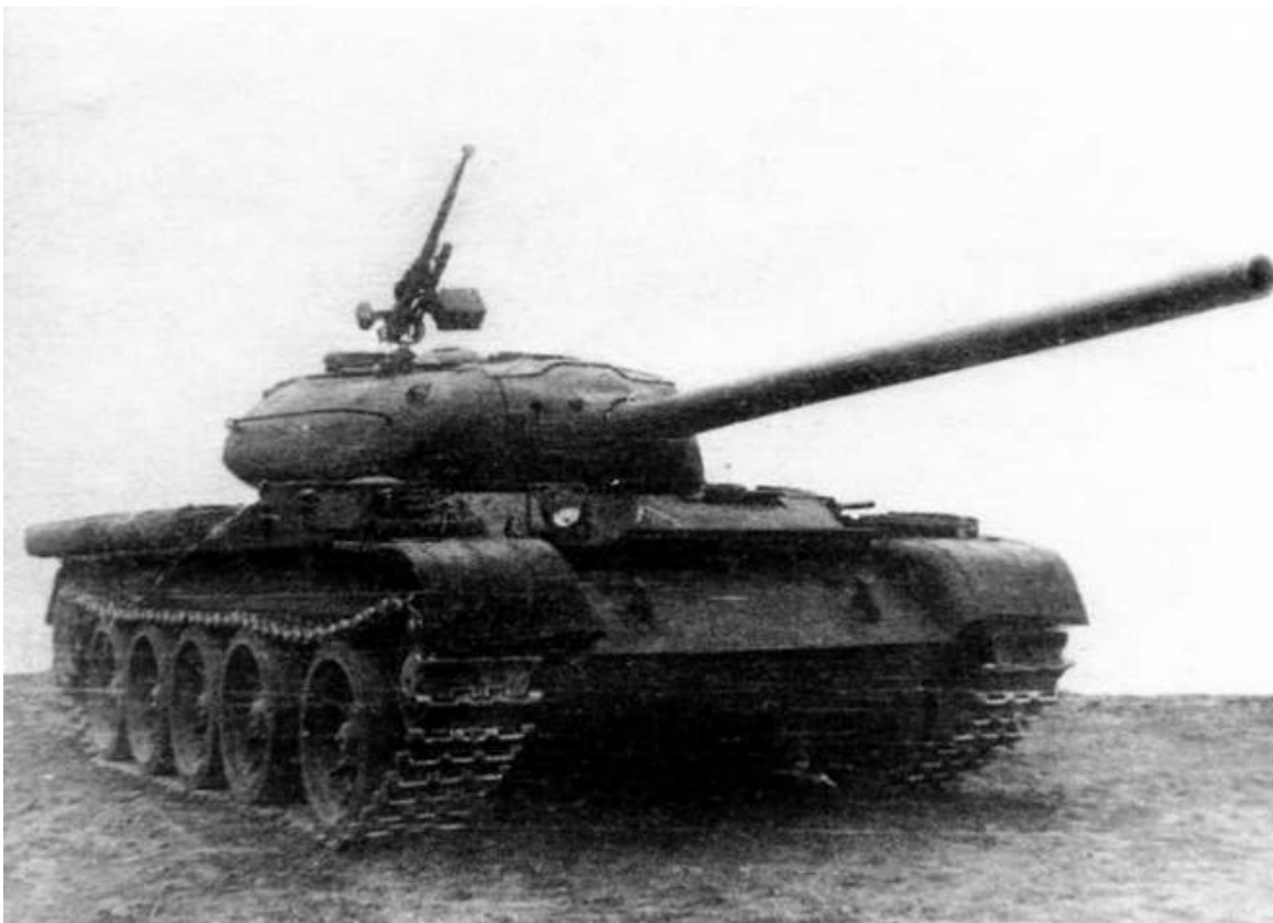
Танк Т-54 выпуска 1946 года во время испытаний. 1947 год. Видны броневые ящики с пулеметами СГ-43, смонтированные на надгусеничных полках
