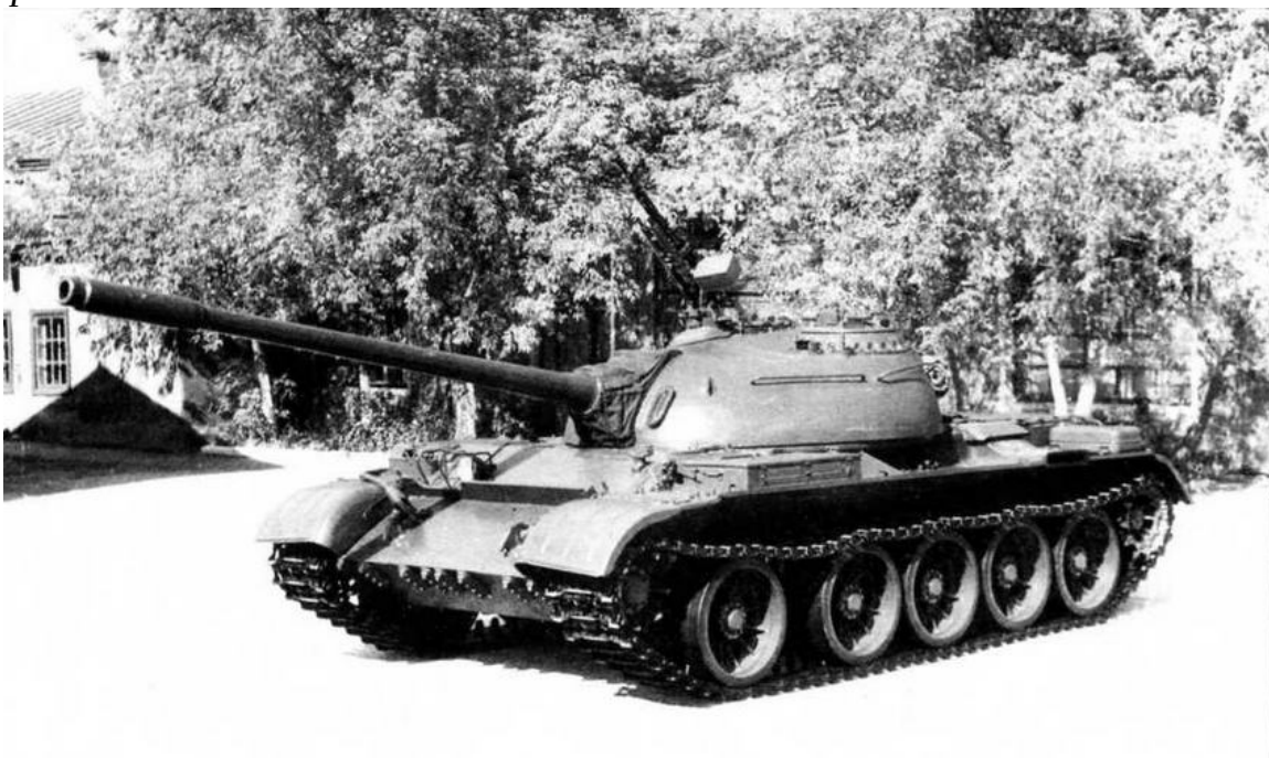
Средний танк Т-54А. Пожалуй, главным внешним отличием от предыдущей модификации был эжектор на стволе пушки
