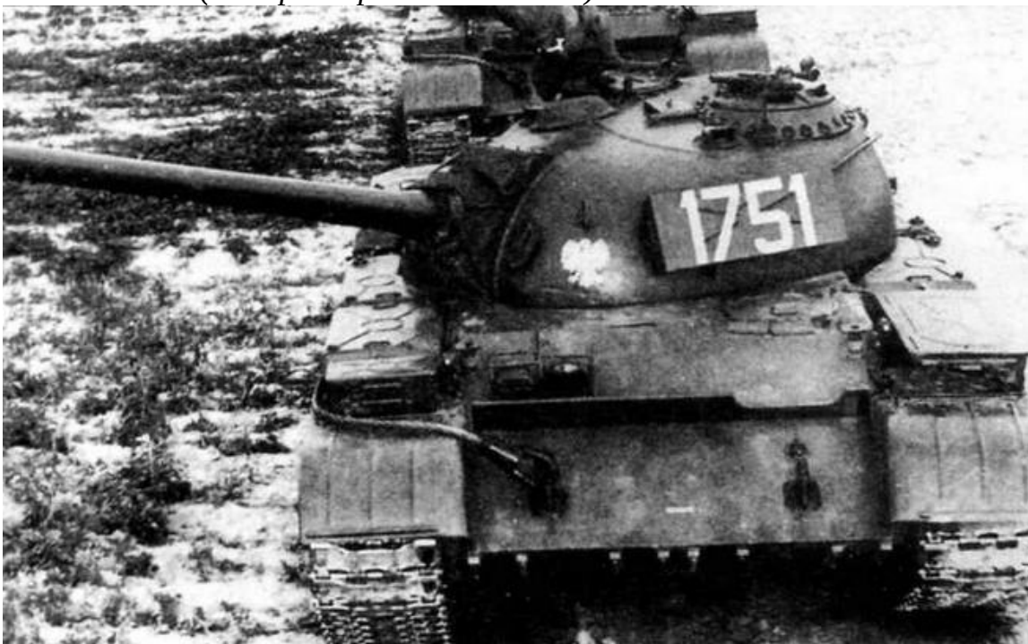
Танк Т-54А польского производства. Характерными внешними отличиями польских машин были L-образные дополнительные топливные
