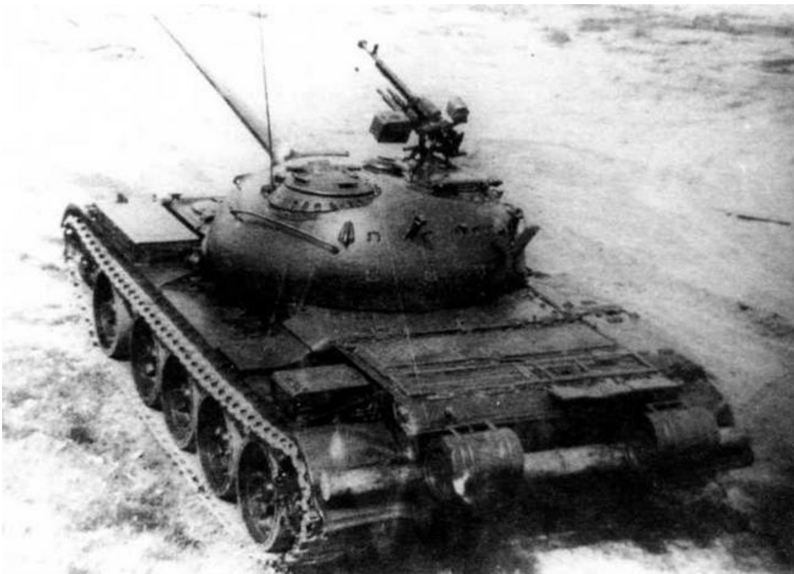
Вид сзади на танк Т-54 обр. 1951 г. Хорошо видна полусферическая форма башни
