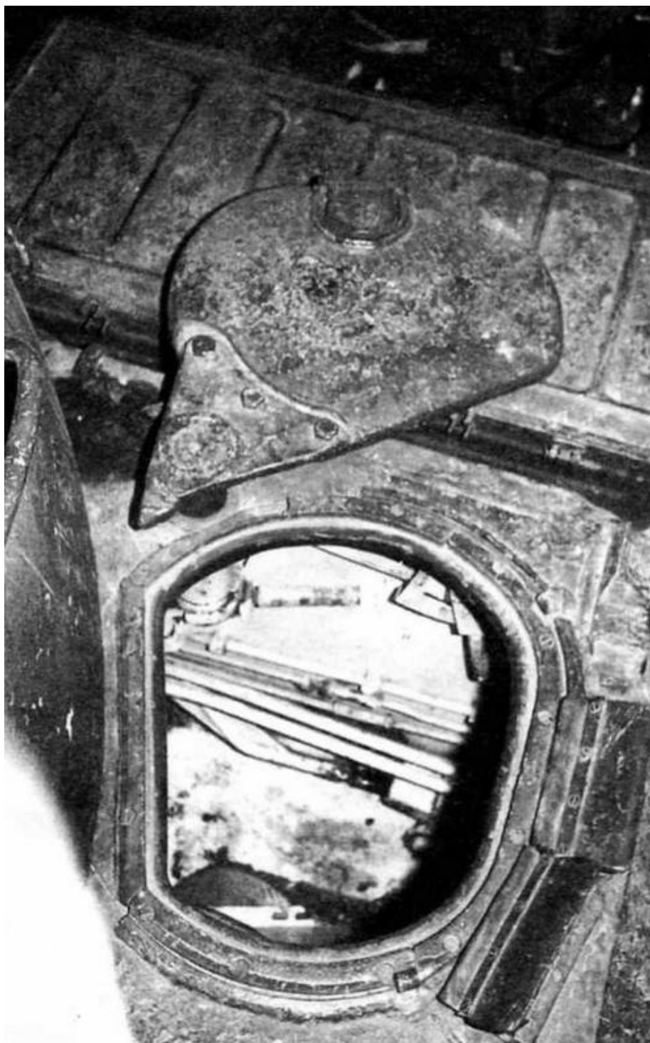
Люк механика-водителя в открытом положении. Крышка сдвинута в сторону. Перед люком установлены призматические приборы наблюдения
