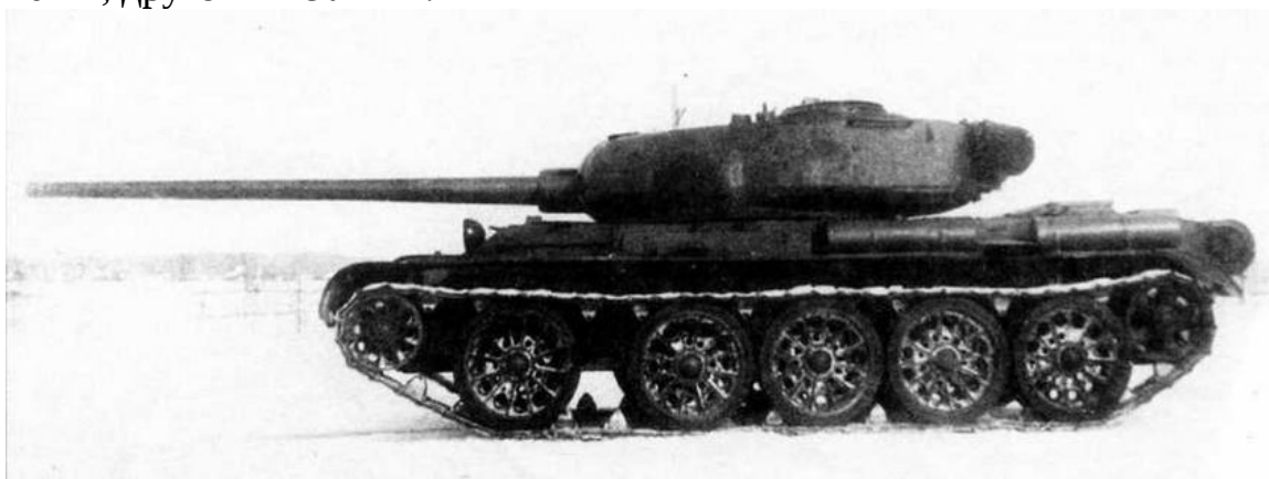
Первый прототип танка Т-54, вооруженный 100-мм пушкой Д-10. Март 1945 года
