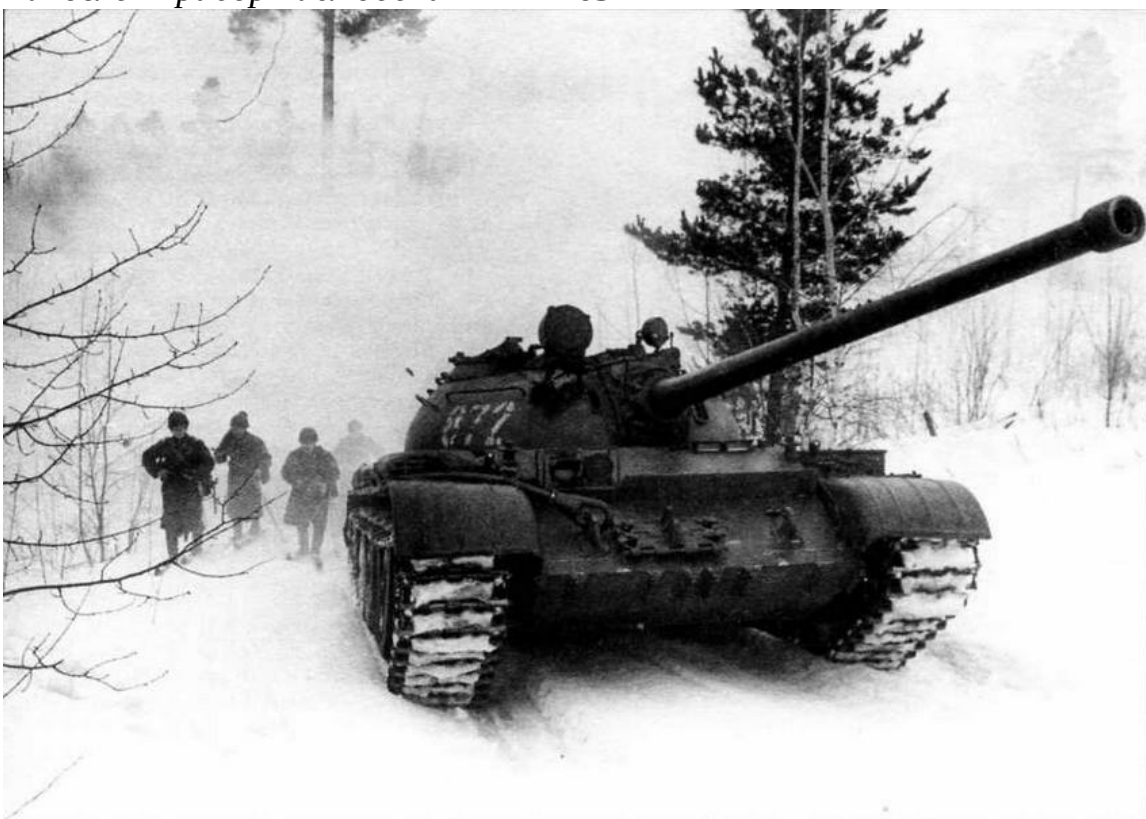
Танк Т-54Б, полученный в результате модернизации Т-54 обр. 1951 г. ИК-прожектор Л-2 установлен на башне; у дульного среза ствола пушки
