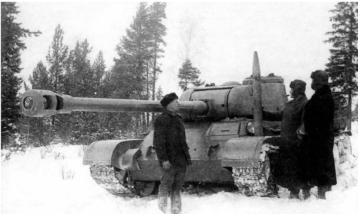
Опытный образец № 3 танка Т-44 со 122-мм пушкой Д-25-44. Февраль 1944 года. На левом подкрылке установлен 122-мм унитарный выстрел, разработанный специально для этой пушки
