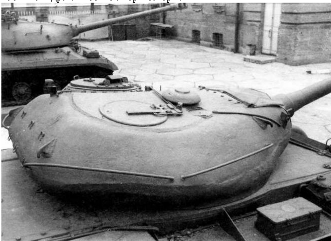
Башня танка Т-54-1. Характерная деталь всех «пятьдесятчетверок» — броневой «грибок» вентилятора в центре крыши
