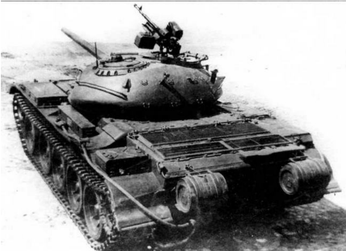
Вид сзади на танк Т-54-2. На надгусеничных полках отсутствуют ящики с пулеметами. Цилиндрические баки заменены на прямоугольные
